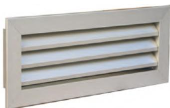
Grelha de ar exterior com alhetas horizontais fixas a 45° passo de 25 mm, com perfil anti-chuva e rede anti-pássaro, acabamento a alumínio RAL 9003. Adequada para caudais superiores a 350 m<sup>3</sup>/h.
