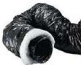
Tubo flexível em PVC ø160 isolado numa camada de poliéster com 25 mm de espessura. Fornecido em rolos de 10 metros. Utilizado para ligar as unidades aos plenos de distribuição.
