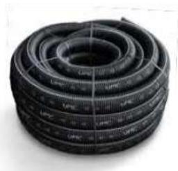
Tubo para distribuição de ar de alta resistência e alta flexibilidade, anti-estático e anti-bacteriano. Tubo com parede exterior em PEAD - Polietileno de Alta Densidade. Sem presença de componentes halogenados. Higienizado contra fungos e bactérias. Fornecido em rolos de 50 metros.
