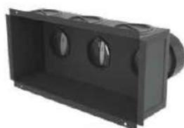
Pleno distribuição de ar em aço pintado a preto, para instalação em parede e com conectores em plástico. Possibilidade de conexão para tubo de 75 ou 90 mm. Possui regulador de caudal por conexão. Possibilidade de alternar em obra os conectores entre parte superior e parte traseira.
